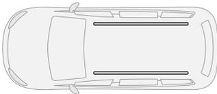
Hierbei handelt es sich um zwei separate Längsschienen. Es muss zusätzlich ein Dachgepäckträger montiert werden. Dachgepäckträger sind fahrzeugspezifische Teile und deshalb sind diese immer passgenau auf das Fahrzeug abzustimmen. Hilfe bei der Auswahl des passenden Dachträgers gibt es im KFZ-Zubehörhandel oder bei einem Fahrzeughändler vor Ort.
