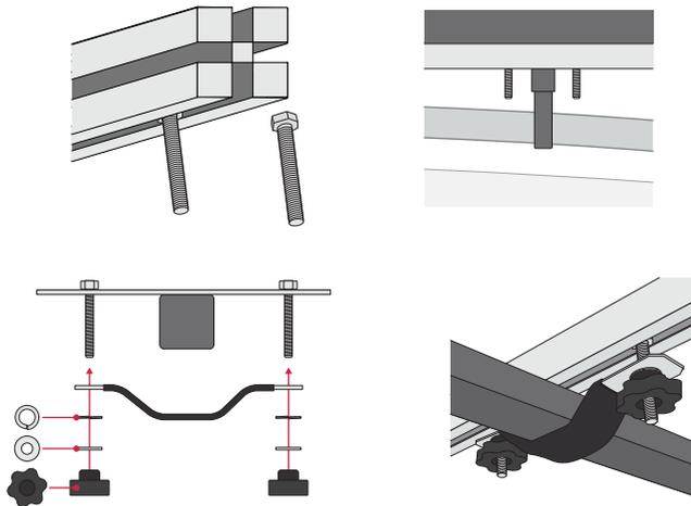
5. Ziehen Sie die Schrauben jedes Fixpunkts der Reihe nach an, decken Sie dann die Führungsschienenabdeckung der Reihe nach ab und überprüfen Sie abschließend erneut den Befestigungsstatus jedes Fixpunkts. Die Installation ist abgeschlossen, wenn es keine Unregelmäßigkeiten gibt. Vorsicht: Achten Sie bitte auf die Reihenfolge der Platzierung der Dichtungen: flache Scheibe- Federscheibe- Knopfmutter.
